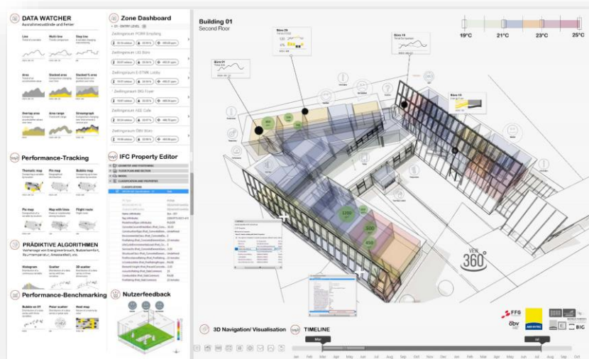
Abbildung 1: buildingtwin.at - BIM-basierte Plattform für Monitoring, Evaluierung und Optimierung des Gebäudebetriebs
